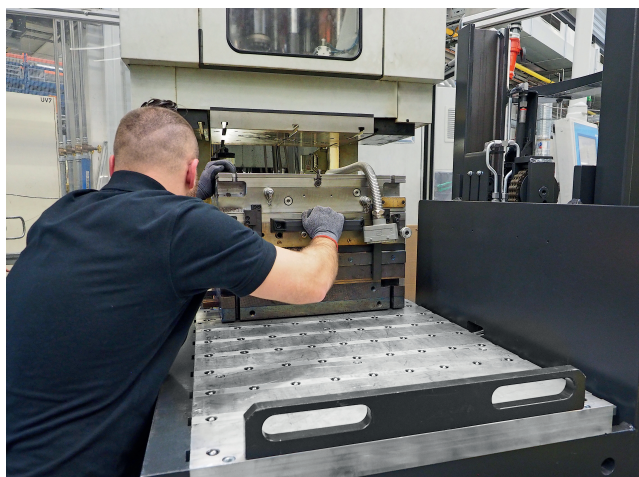
Bild 1. Der Wechselwagen kann direkt an die Spritzgießmaschine gefahren werden. Durch die hydraulischen Kugelleisten lassen sich auch schwere Werkzeuge leicht in jede Richtung verschieben © Römheld
