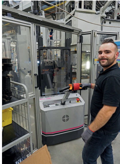
Bild 2. Bedient wird der RWA 1600 über eine Multifunktionsdeichsel, an der sich unter anderem die Geschwindigkeit und die Höhe der Hubplattform einstellen lassen © Römheld
